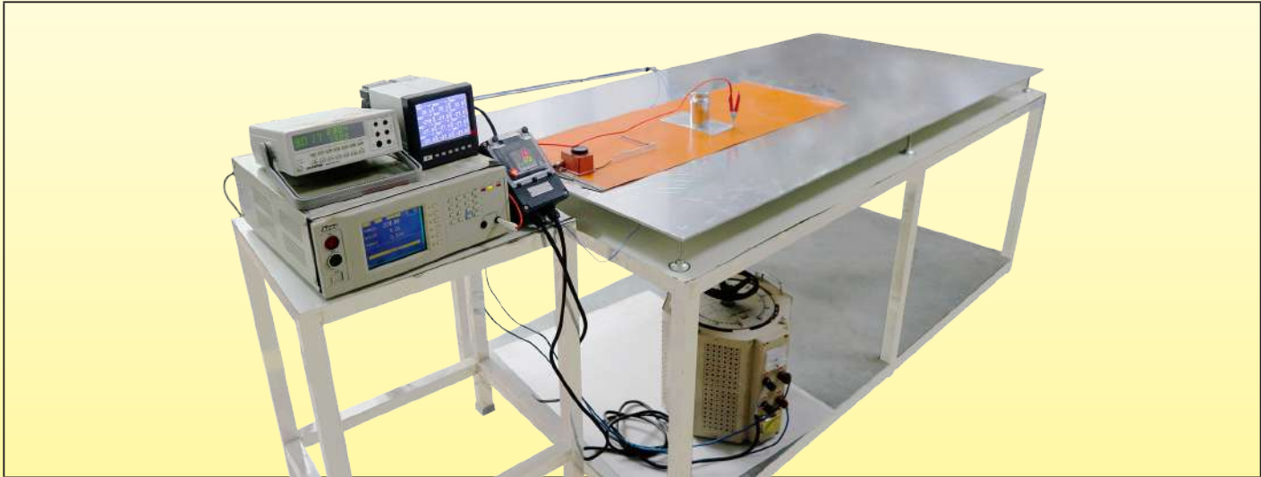
Messgeräte für den Gesamtleckstrom im heißen Zustand
